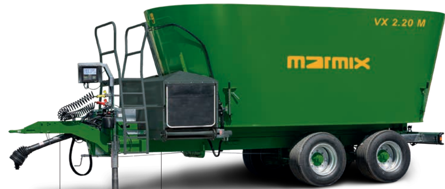
Höhenverstellbare Zugdeichsel (Optional Kugel-Zugöse K-80)
