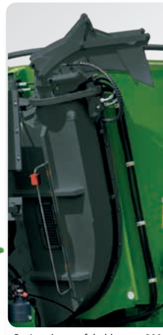
Option: Auswurf drehbar um 300°
