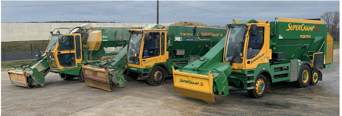
Die verschiedenen Entwicklungsstufen des „Super Champ“. Das neue Modell hat eine zusätzliche Liftachse.
