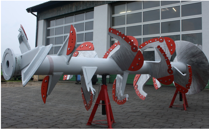
Die Rührflügelwelle besteht aus asymmetrisch angeordneten Flügeln, was ein Verklumpen verhindert.
