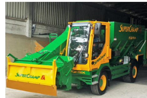
Super Champ FA - neueste Generation mit Allradlenkung & Allradantrieb - Entwicklung 2020
