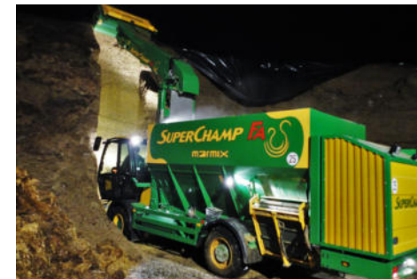
Super Champ FA - Horizontaler Selbstfahrer mit Teleskopfräse (Höhe 6,50 m) - Entwicklung 2009
